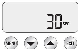
Le minuteur de l'espresso apparaîtra durant l'extraction et 10 secondes après, puis retournera au mode d'affichage par défaut de la température de l'espresso.
