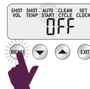
Pressez la flèche du HAUT ou celle du BAS pour régler le démarrage automatique à ON ou OFF (marche ou arrêt).
