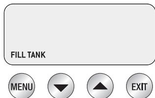
Remplissez le réservoir d'eau froide. La machine ne pourra chauffer le café ou fournir de l'eau chaude si le réservoir est vide.
