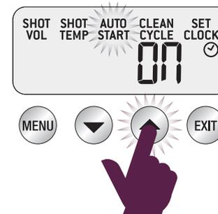
Si OFF (arrêt) est sélectionné, pressez la touche EXIT pour régler le démarrage automatique.
