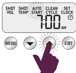
Pressez la touche EXIT pour régler le démarrage automatique. Une petite icône d'horloge apparaîtra sur l'écran ACL, une fois la fonction programmée.
