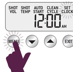
Pressez la flèche du HAUT ou celle du BAS pour régler l'heure. Pour accélérer le défilement, appuyez et tenez la flèche du HAUT ou celle du BAS. Pressez la touche EXIT pour régler l'heure.
