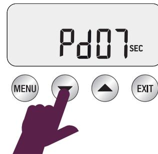
Nous recommandons une durée maximale entre 5-15 secondes. Pressez la touche MENU pour accéder à la puissance de préinfusion (PP), ou la touche EXIT pour régler la durée sélectionnée.
