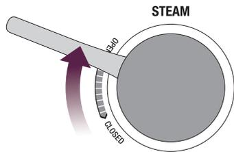
Pour arrêter la vapeur, déplacez le LEVIER DE VAPEUR à la position fermée (CLOSED). La machine retournera en mode VEILLE.
