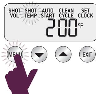
Appuyez sur la flèche du HAUT ou celle du BAS pour ajuster la température. La température par défaut est de 200°F (93°C) mais peut être modifiée à 190°F - 205°F (86°C - 96°C).
